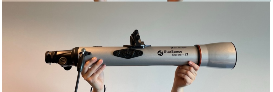
Statief en telescoopbuis met zoeker (deze is al gemonteerd).
